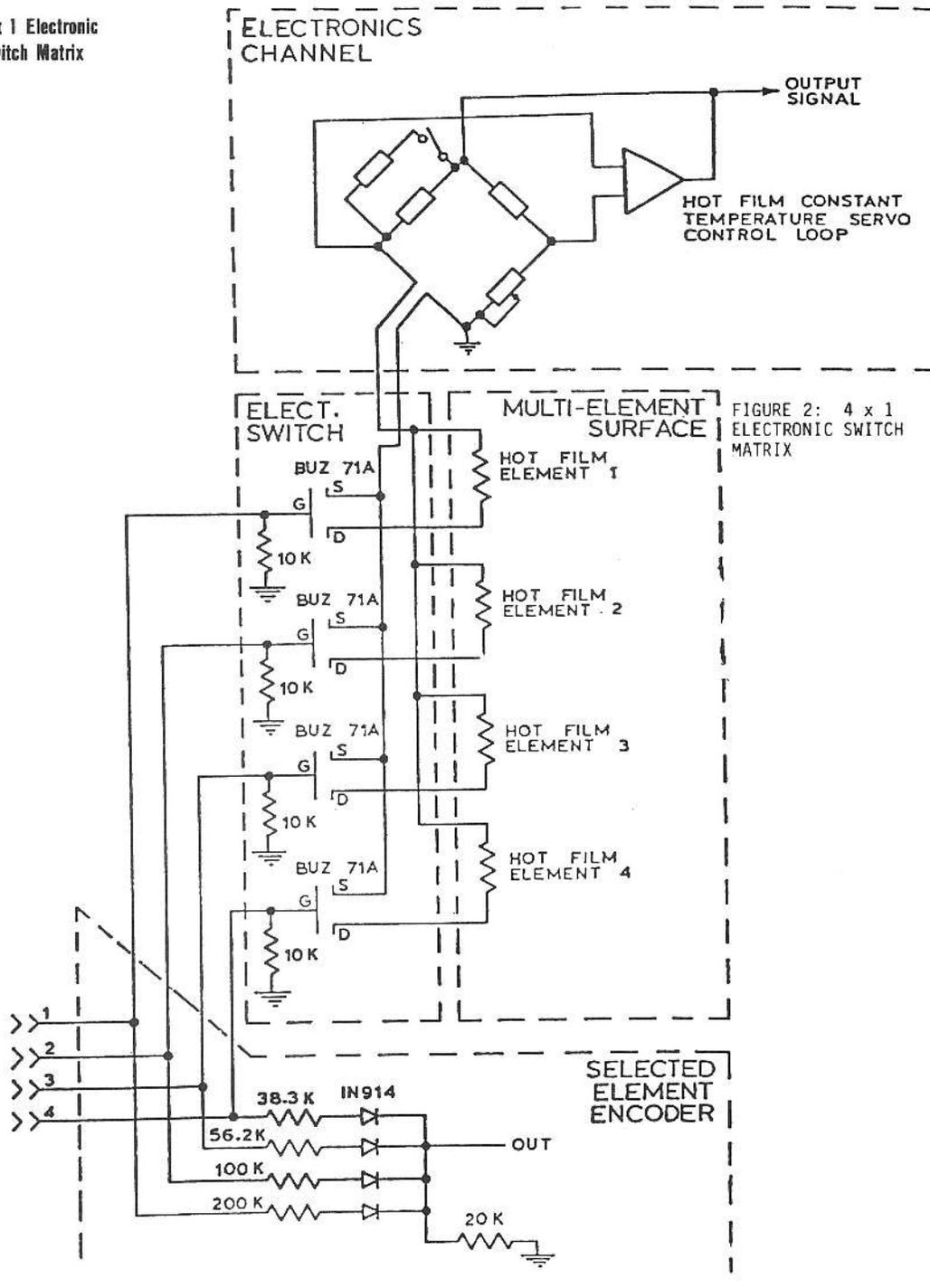
FIGURE 2: 4 x 1 ELECTRONIC SWITCH MATRIX
